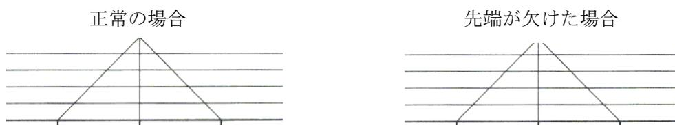
図 2. 正常な三角図票と原稿枠が欠けたことを示す三角図票
