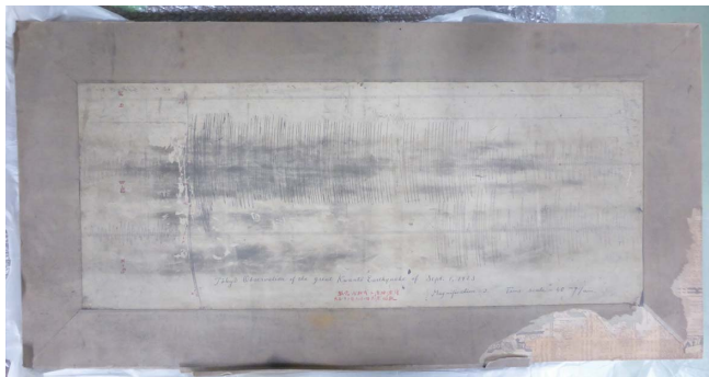
写真4 今村式2倍強震計によって観測された関東地震の本郷での記録のコピー
