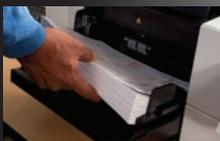
超音波重送検知センサーで書類の重複を防ぎます。
